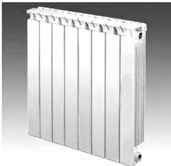
Этот радиатор имеет важную отличительную особенность: его внутренняя часть, находящаяся в непосредственном контакте с водой, выполнена из стали, а наружная - из алюминия, передающего тепло окружающей среде. Комбинированное использование металлов позволило добиться новых результатов:
